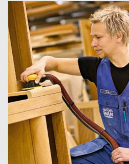
**BESSERE KONTROLLE.** Staubfreies schleifen ermöglicht eine bessere Kontrolle über die Schleifarbeit. Viele verschiedene Arbeitsprozesse können im gleichen Raum parallel durchgeführt werden. Und natürlich fällt weniger Aufräumarbeit an!
