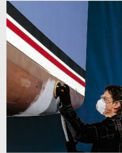
**SCHUTZ DER LUNGE.** Dank Abranet wird die Lunge eines Arbeiters einer viel geringeren Menge Staub ausgesetzt. Mit einer guten Staubabsaugung können auch Spezialmetalle wie Zink und Aluminium, sowie Verbundwerkstoffe wie Kohlefaser und Glasfaser geschliffen werden.
