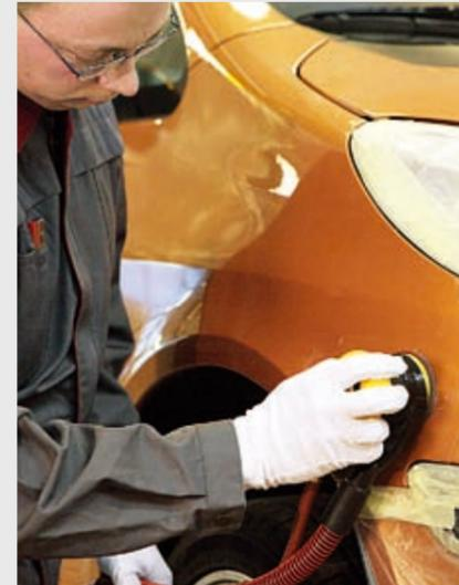
**SCHNELL UND EFFEKTIV.** Mit Abranet schleift man staubfrei und effektiv während des ganzen Arbeitsprozesses – vom Füllerschleifen bis zur Abschlusspolitur. Das spart Zeit und garantiert eine bessere Qualität.
