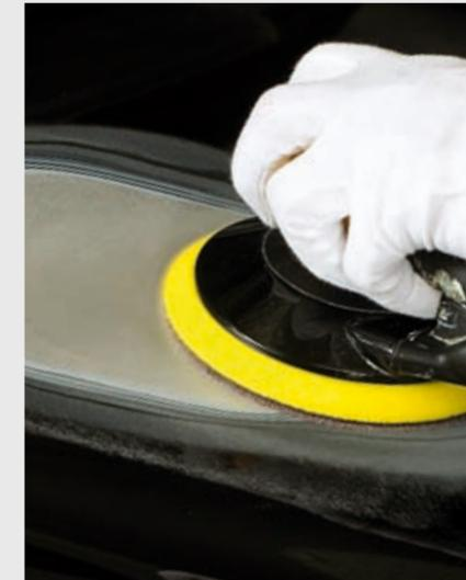
**ALUMINIUM.** Metalle wie Aluminium, werden immer mehr in modernen Autos verarbeitet. Das Schleifen dieser Materialien erfordert eine effektive Staubabsaugung sowohl aus produktionstechnischen, als auch aus gesundheitlichen Gründen.
